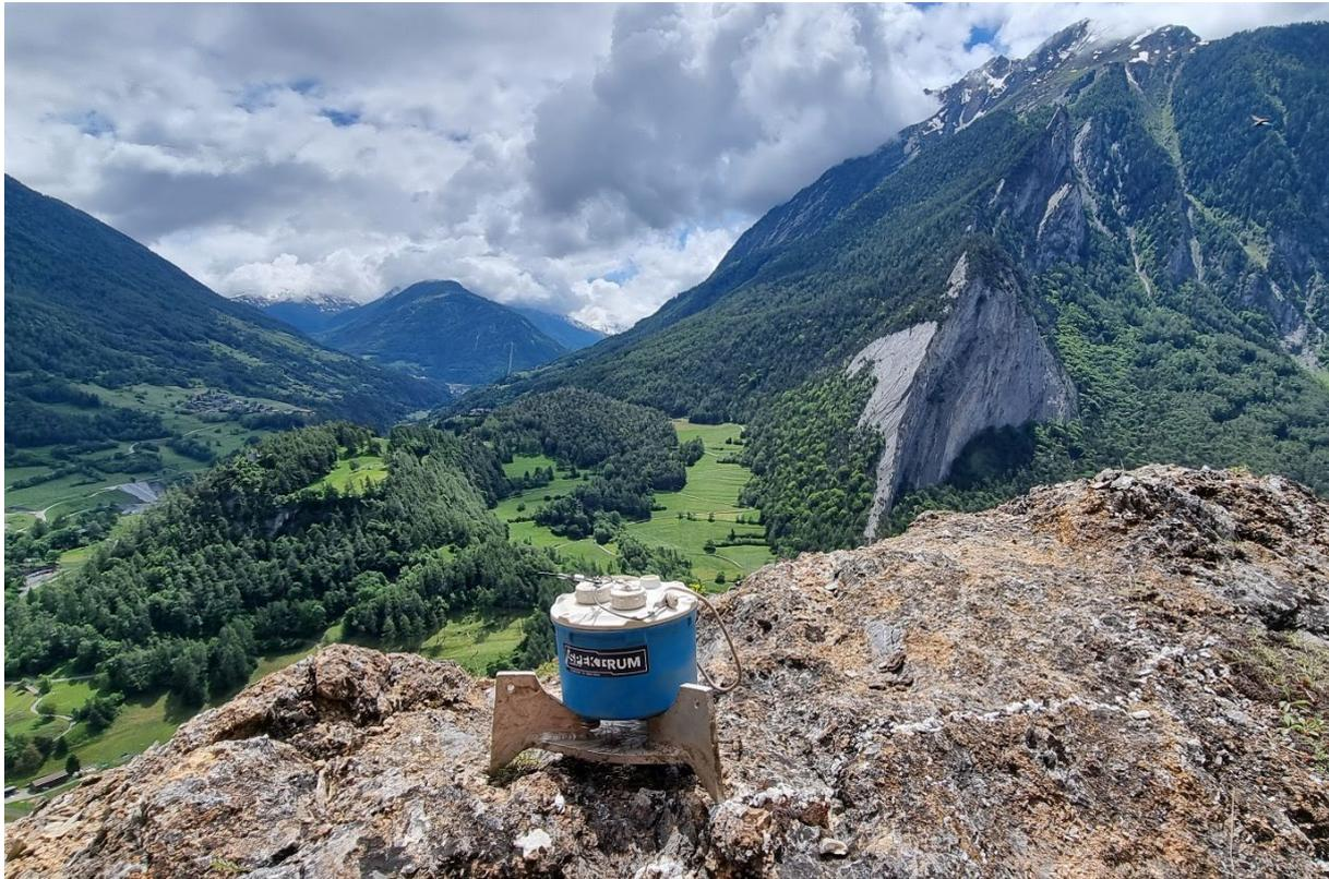
Abb. 10: Portabler Seismometer zur Messung der Bodenunruhe im Rahmen einer passiv-seismischen Kartierung.
