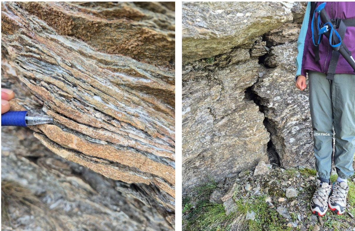
Abb. 6: Links: Lösungserscheinungen innerhalb der Schieferungslagen. Rechts: Detailaufnahme einer typischen Kluft wie sie im Bereich der Abrisskanten vorkommt: steil stehenden mit stark stufiger, rauher Oberfläche.
