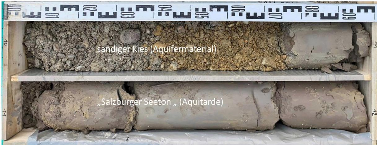
Abb. 14: Übergang vom Aquifermaterial zur Aquitarde (Laufmeter 10 – 12 der Bohrung BL1)
