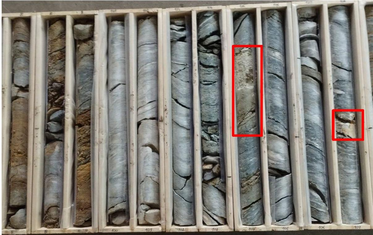
*Abb. 4: Bohrkern der Bohrung L-KB-16/19 (97-108 m Teufe): Kalkglimmerschiefer und Grünschiefer der Bündnerschiefer-Gruppe mit porösen Bereichen (links, rostbraun) und grusigen Lagen (rot umrandet).*
