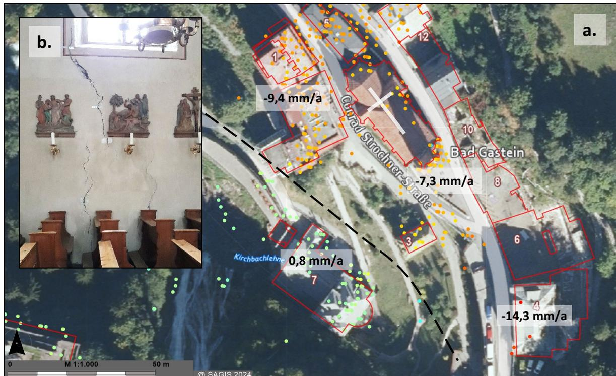
Abb. 8: a. Ausschnitt aus SAGISonline im Bereich des Wasserfalls N' des Straubinger Platzes mit farbigen TerraSAR-X Datenpunkten (Descending-Mode) und mittleren LOS-Verschiebungsraten sowie rot umrandeten Gebäuden. Schwarz strichliert die ungefähre Grenze zwischen bewegt und unbewegt. In Abb. b. sind Risse in dem Mauerwerk der Preimskirche zu erkennen, die in Abb. a. mit einem weißen Kreuz markiert ist.
