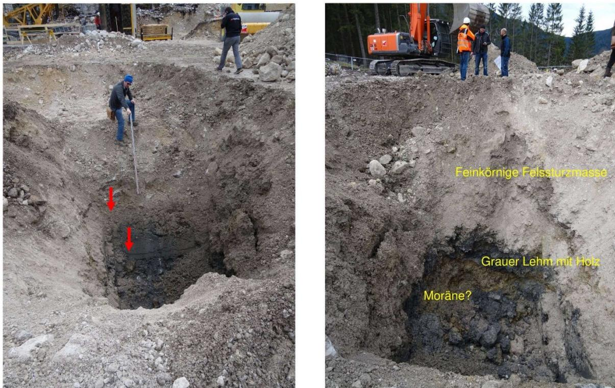
Abb. 2: Schurfschlitzte Talstation Seilbahn Zugspitze am Eibsee
