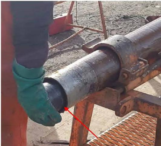
Doppelkernrohr mit PE-Inliner DN100
