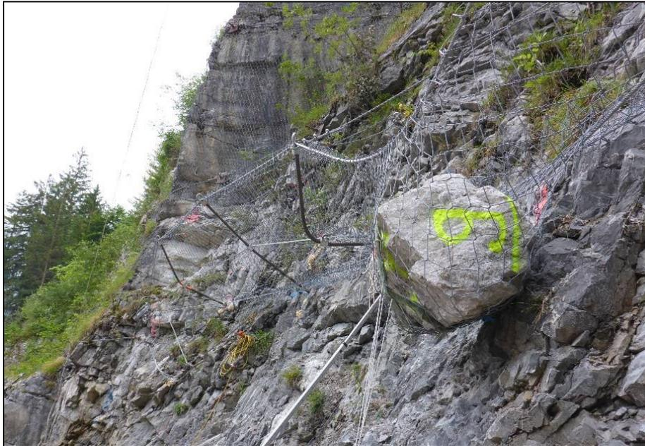
**Abb. 7:** Belasteter Zaun aus dem Feldversuch
